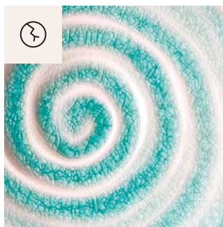
neigt zu Cracks | crazing possible
