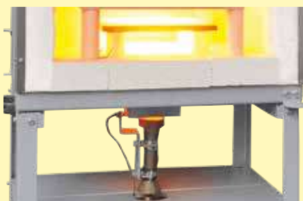
Brûleur à gaz propane de 15 kW monté sous le four
