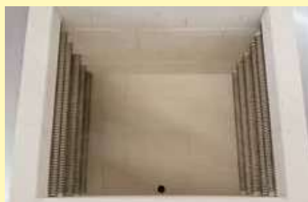
Des résistances chauffantes sur tubes supports veillent à un rayonnement libre de la chaleur
