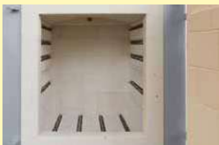
Chauffage sur trois côtés avec éléments chauffants protégés dans des rainures
