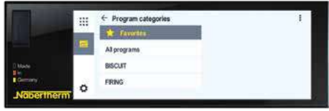
Les programmes de température peuvent être enregistrés comme favoris et dans des catégories
