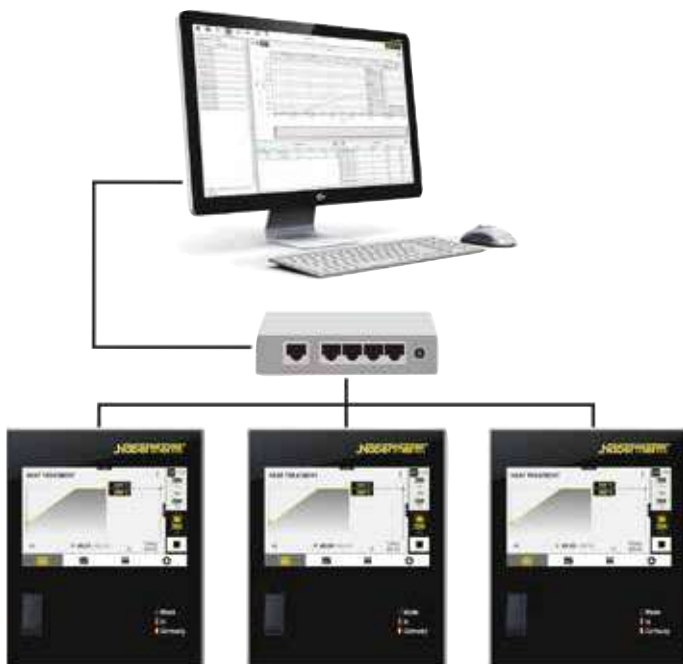
Exemple de montage avec 3 fours
