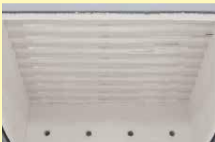
Dicht nebeneinander angeordnete Deckenheizelemente, geschützt in Quarzglasrohren
