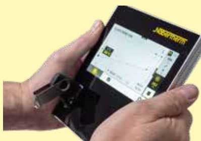
Aufzeichnung von Prozessdaten des angeschlossenen Controllers per USB-Stick
