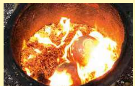
Abkühlen und Eintauchen des Brennguts in Laub, Stroh oder Späne
