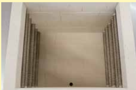
Heizelemente auf Tragerohren sorgen für eine freie Wärmeabstrahlung
