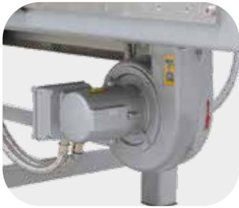
Kühlgebläse zum beschleunigten Abkühlen bei geschlossenem Deckel
