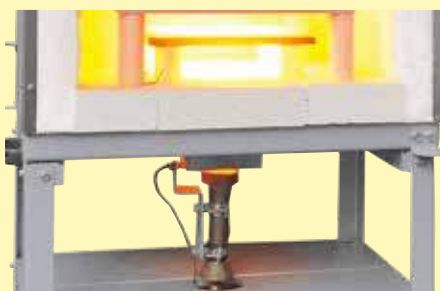
Propangasbrenner mit 15 kW unter dem Ofen montiert
